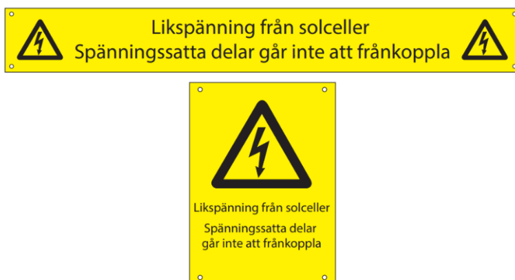
Figur 4. Uppmärkning av likströmskablage.
